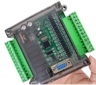
Ilustración 6 Imagen de PLC
