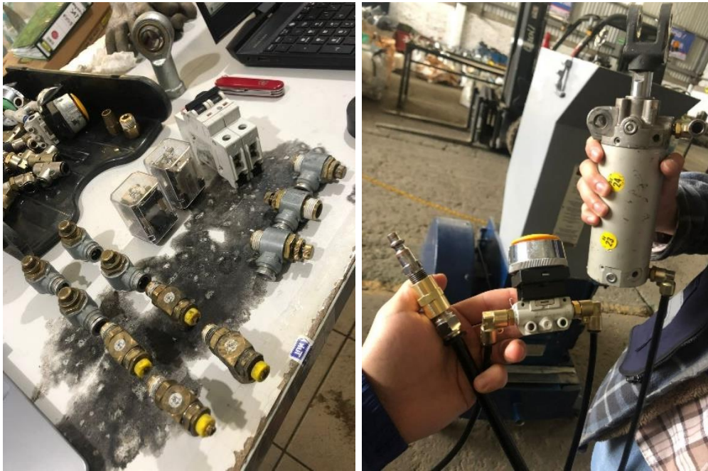
Ilustración 33 Materiales verificados: Interruptor, válvulas reguladoras, Push button, cilindro de doble efecto
